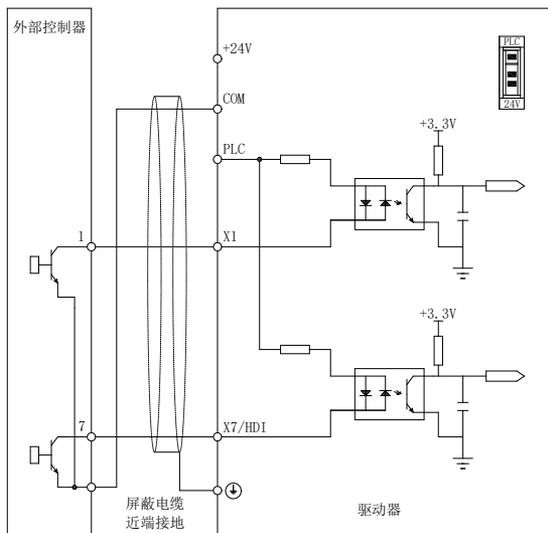
图 2-9 使用内部电源开路集电极 NPN 接线方式
