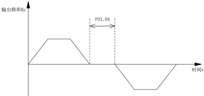
图 5-2 正反转死区时间示意图
