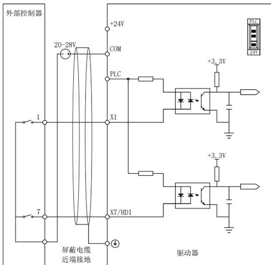
图 2-8 使用外部电源干接点方式
