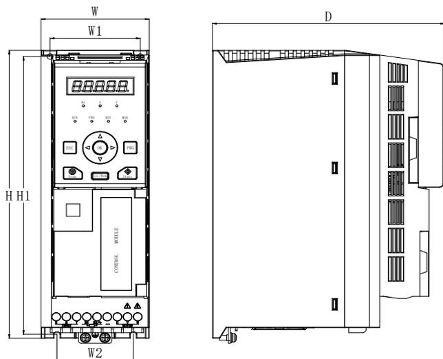
图 8-1 XXX-4T5.5GB 及以下功率等级安装尺寸示意图
