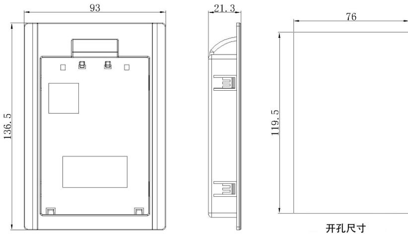
图 8-7 操作键盘托盘外形尺寸
