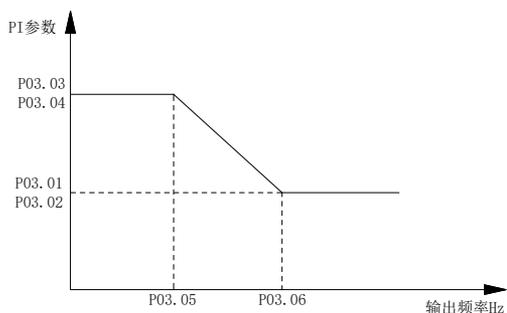
图 5-5 速度环 PI 参数示意图
