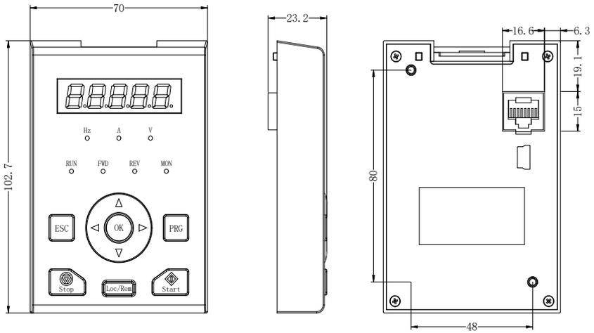
图 8-6 操作键盘外形尺寸
