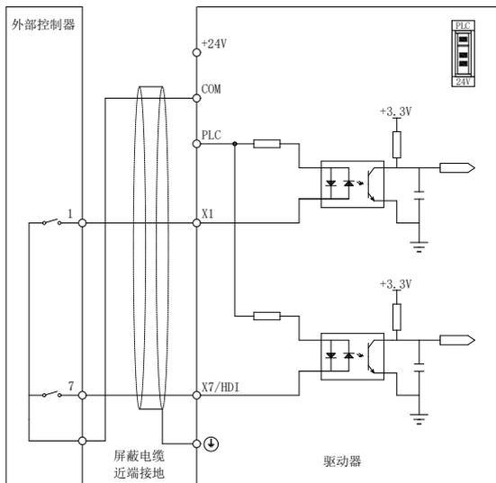
图 2-7 使用内部电源干接点方式
