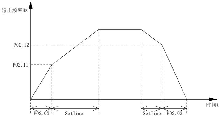
图 5-4 折线加减速时间切换示意图
