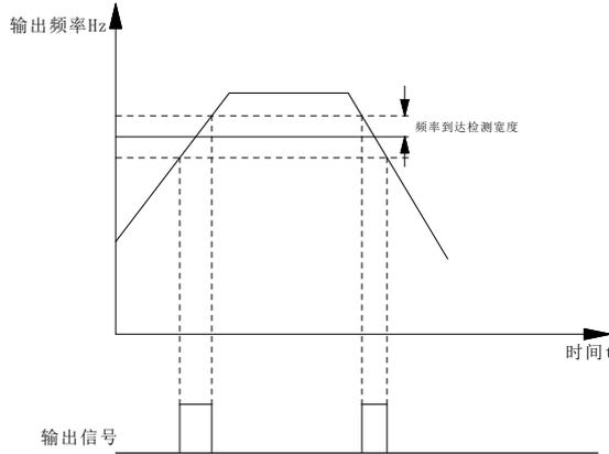
图 5-14 频率到达检测示意图
