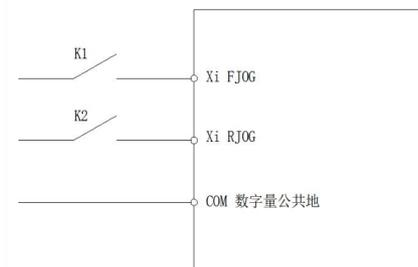
图 5-11 两线式模式示意图
