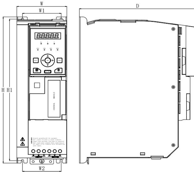
图 8-2 XXX-4T7.5GB~XXX-4T15GB 安装尺寸示意图
