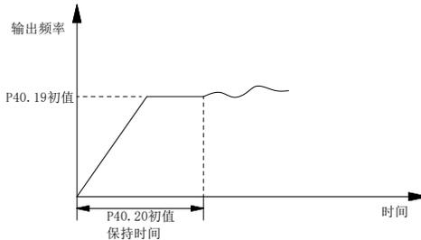
图 5-21 PID 初值功能示意图
