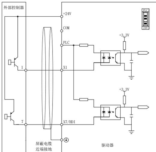
使用外部电源的开路集电极 PNP 接线方式，拨码开关 S700 选择及接线如图 2-12 所示。
